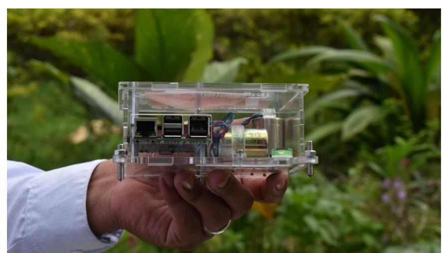
Mientras que los acelerómetros están diseñados para detectar sismos de mayor intensidad. Gracias a su amplio rango dinámico, estos sensores no se saturan ante movimientos fuertes, lo que los convierte en una herramienta fundamental para el registro de sismos significativos y para alimentar la aplicación de la alerta temprana de terremotos.
