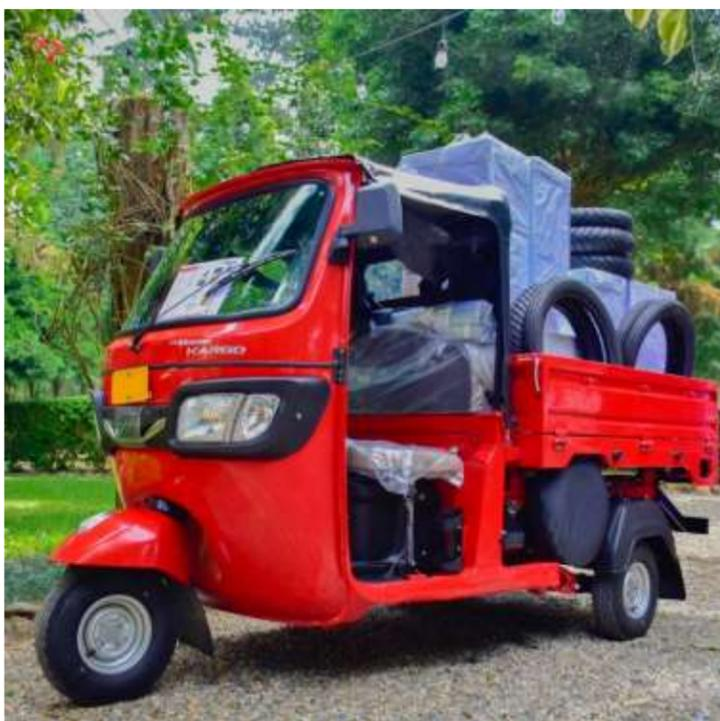
En esta ocasión el King Kargo viene equipado con un motor de 225cc con refrigeración por líquido, entendiéndose un sistema de refrigeración dedicado en lugar de refrigeración por aire, encendido eléctrico silencio libre de mantenimiento, puerto de carga USB y un tanque de gasolina de 15 libras, prometiendo no solo potencia, sino también eficiencia y una conducción suave.
