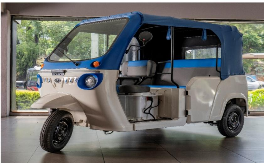
El nuevo Mahindra Treo cuenta con tren motriz y rendimiento eléctricos mejorados, brinda rendimiento y eficiencia. Con tecnología de batería mejorada y sistemas avanzados de motor eléctrico, el Treo ofrece mayor autonomía, hasta 130 kilómetros con una sola carga, tiempos de carga más rápidos que oscilan desde menos de 4 horas hasta 8 horas dependiendo el voltaje y aceleración superior a vehículos de tres ruedas con motores convencionales tanto en calles planas como inclinadas.
