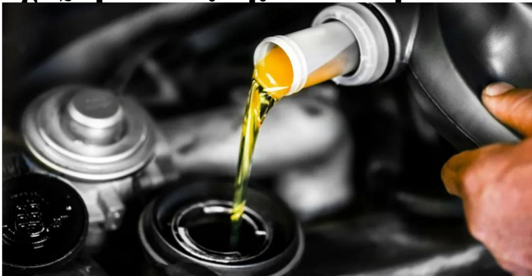
El aceite es esencial para el funcionamiento correcto del motor de un automóvil por varias razones, Este actúa como un lubricante esencial en el motor, reduciendo la fricción entre las piezas móviles, como los pistones, las bielas y el cigüeñal.
